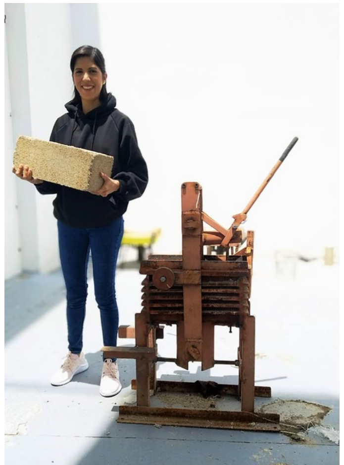
Prensa para prototipar ecobloques, proceso de experimentación.
